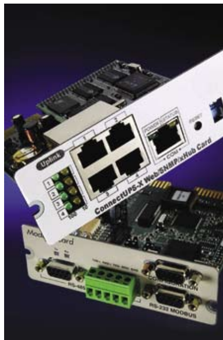
Адаптеры для X-Slot интегрируют BladeUPS в системы мониторинга и информируют администраторов о параметрах его работы.
