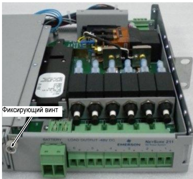
Рис 16. Демонтаж блока MFU.
